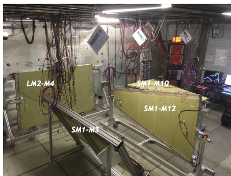
Σχήμα 12: Η πειραματική διάταξη επικύρωσης υψηλής τάσης του Micromegas στο BB5.
