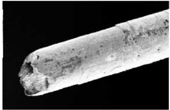
(d) Gerissener Draht. Man erkennt die Stufe, an der zuerst die Goldschicht weggeätzt wurde, bevor das Wolfram zutage trat.
