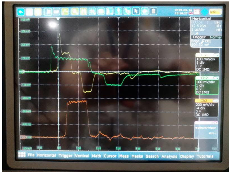
Figure 32 : Signaux de pick-up du KFA45 lors du test avec le ThyPTM
