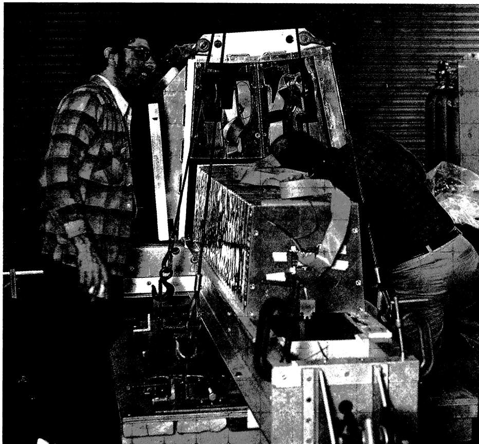
Travaux en cours dans les entrailles de l'un des prototypes de calorimètre à uranium essayés l'année dernière pour le détecteur SLD construit actuellement pour le nouveau collisionneur linéaire de Stanford. Après des études poussées, un modèle plomb-argon liquide a été choisi.
