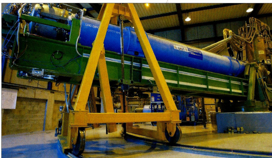
L'hélioscope à axions CAST, construit à partir d'un aimant d'essai du LHC, pointe vers le Soleil chaque jour à l'aube et au crépuscule.
