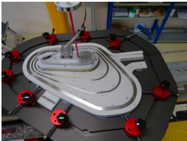
Figura 4.3: Primo strato di prototipo "fantoccio" di GaToroid, avvolto in nastro di acciaio inossidabile su distanziatori in nylon misto vetro (in bianco).
