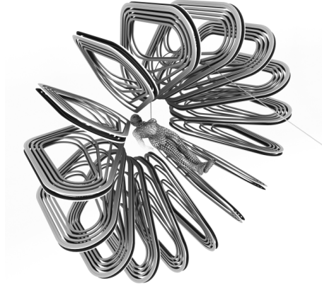
Figura 4.1: Rappresentazione artistica delle 16 bobine GaToroid per protoni, con il paziente posizionato all'interno dell'apertura per il confronto delle dimensioni (per gentile concessione di Daniel Dominguez, CERN Design and Visual Identity Service).
