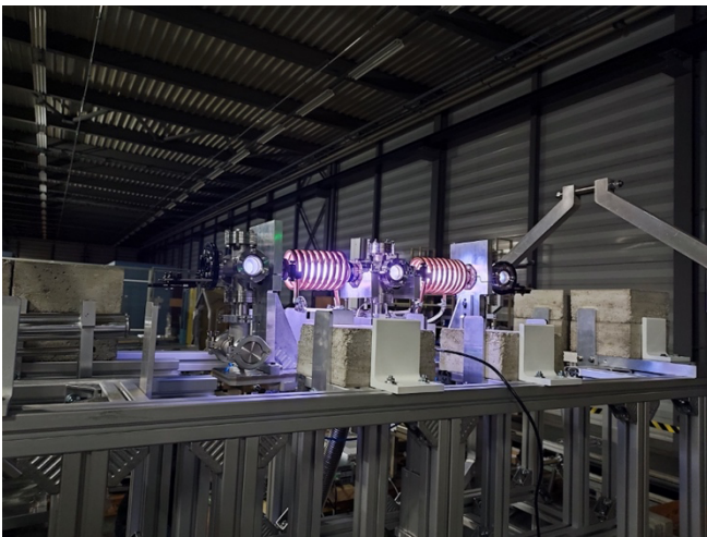
La cellule plasma destinée à l'expérience Fireball, prête à être transportée vers la zone d'irradiation d'HiRadMat. (Image: CERN)
