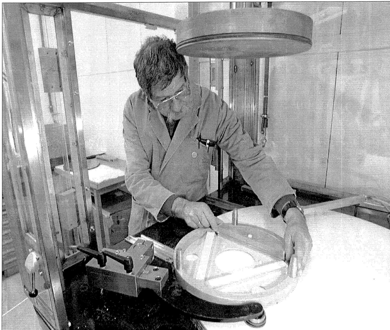
Montage de cristaux dans la machine à polir.
