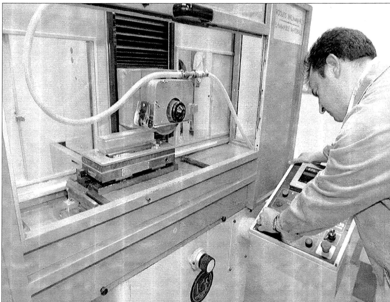
Cristal à la coupe! Cette machine, mise au point au CERN et fabriquée à Lyon, taille des monocristaux de tungstate de plomb selon la forme désirée.
