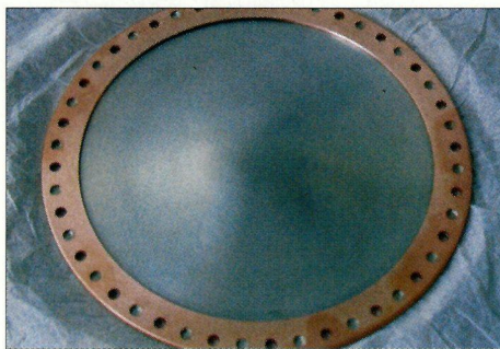
Les hublots sur mesure en béryllium de la cavité RF qui apportent un doublement du champ électromagnétique.
