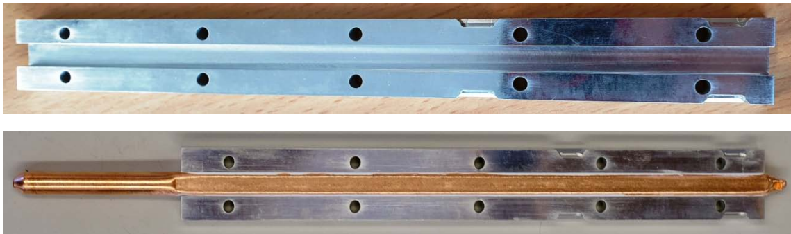
Figure 3.63 Heat spreader clamp with water-filled copper heat pipe pressed inside Rysunek 3.63 Zacisk radiatora DCB z wypełnioną wodą miedzianą rurką cieplną wewnątrz
