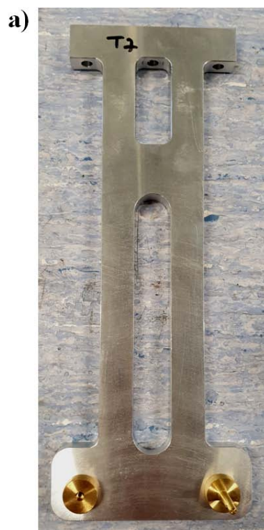
Figure 4.24 a) Stave support; b) Brass pins for stave mounting Rysunek 4.24 a) Podpora stave'a; b) Mosiężne piny do mocowania stave'a
