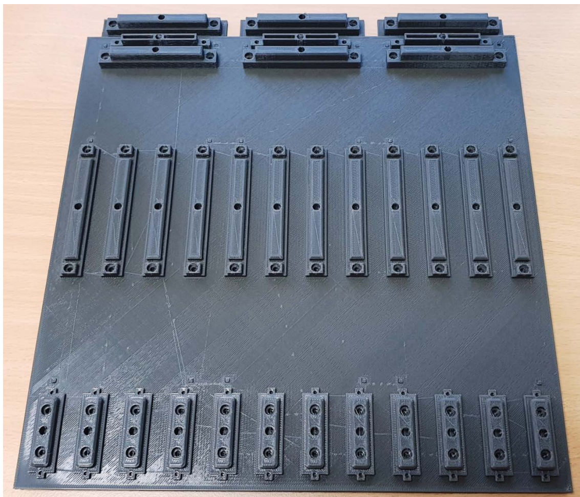
Figure 4.6 3D printed backplane Rysunek 4.6 Backplane wydruk 3D
