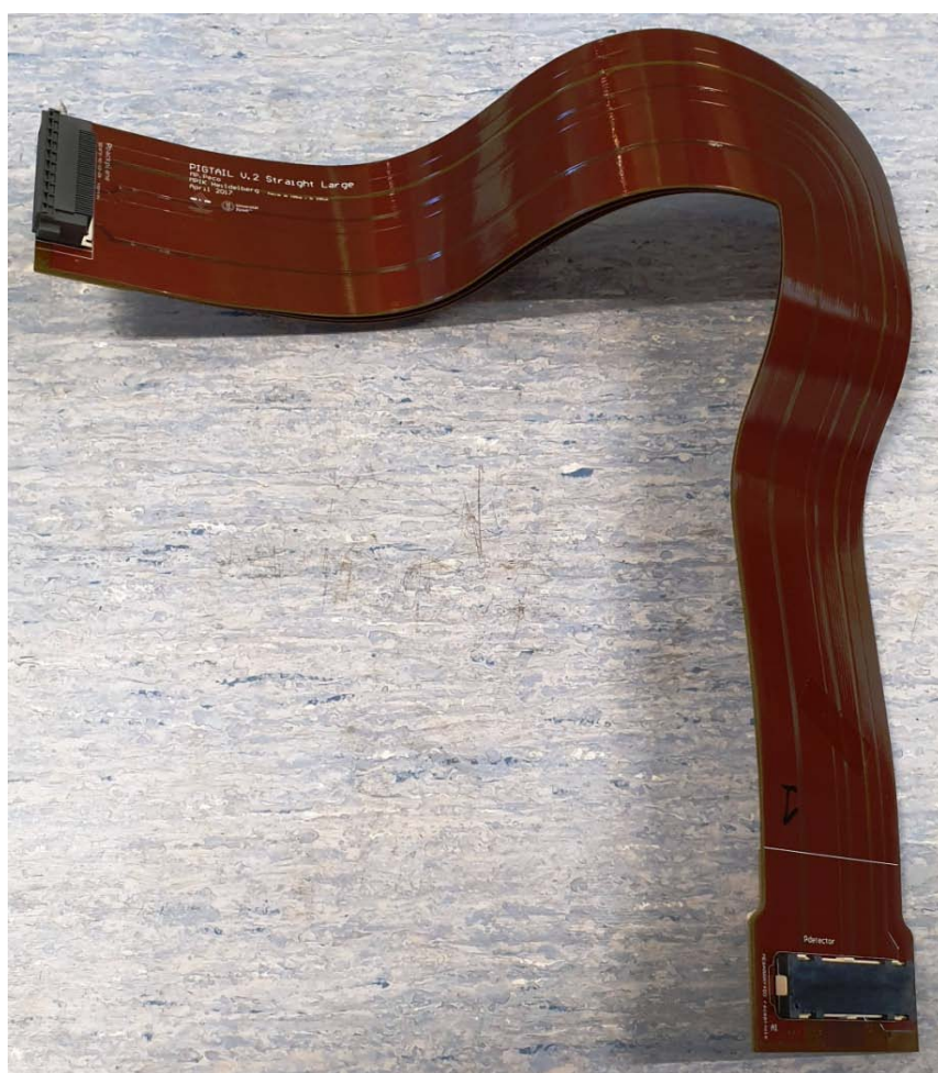
Figure 4.26 Full size data read-out cable (pigtail) with connectors on both ends Rysunek 4.26 Kabel odczytu danych w pełnym rozmiarze z konektorami na końcach
