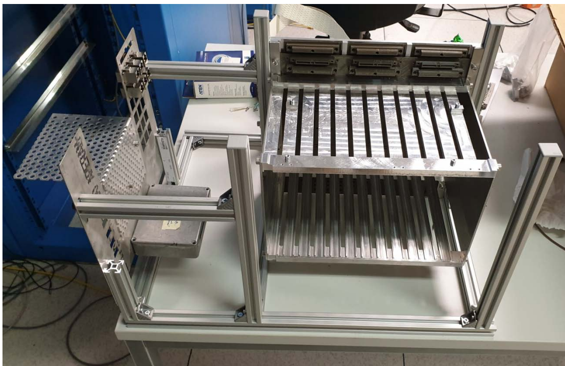
Figure 4.23 Pathfinder crate with patch panels for slice test Rysunek 4.23 Krata pathfinder z panelami przejściowymi dla slice testu
