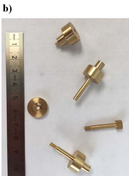
Figure 4.24 a) Stave support; b) Brass pins for stave mounting Rysunek 4.24 a) Podpora stave'a; b) Mosiężne piny do mocowania stave'a
