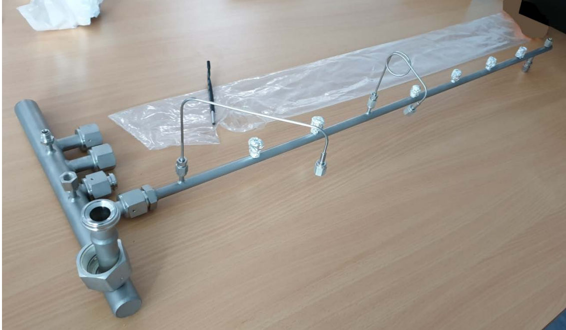
Figure 3.31 CO 2 cooling manifold prototype [33] Rysunek 3.31 Prototyp kolektora chłodzącego CO 2 [33]
