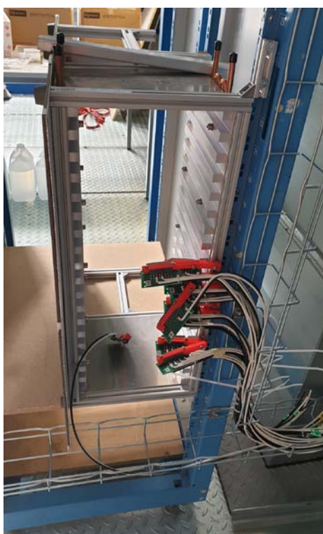
Figure 4.34 Service bays crate placed inside slice test rack Rysunek 4.34 Krata serwisowa umieszczona w szafie slice testu
