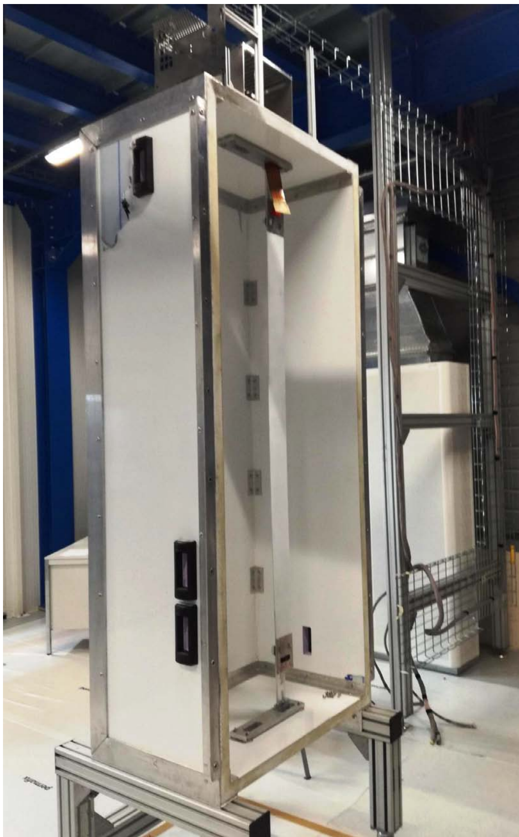
Figure 4.22 Slice test box with dummy stave installed Rysunek 4.22 Skrzynka slice testu z zainstalowaną makietą stave'a
