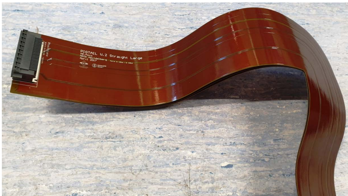
Figure 4.25 Data read-out cable (pigtail) PEPI volume part Rysunek 4.25 Kabel odczytu danych część znajdujaca się wewnątrz PEPI
