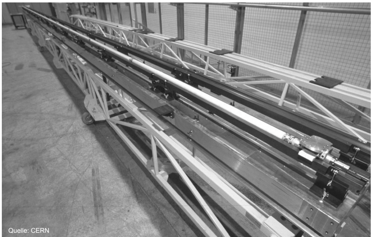
Abb. 4-1 Segmentierte Keramik-Schub-/Drehstange (weiß) zum Positionieren einer Drehspule Segmented ceramics pole (white) for positioning and turning of a measuring coil
