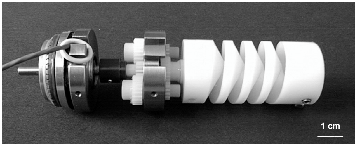
Abb. 7-15 Shinsei-Motor (links) mit spielfreiem 3:1 Getriebe und Helixkupplung Shinsei Motor (left) with low clearance 3:1 reduction gear and helical coupling
