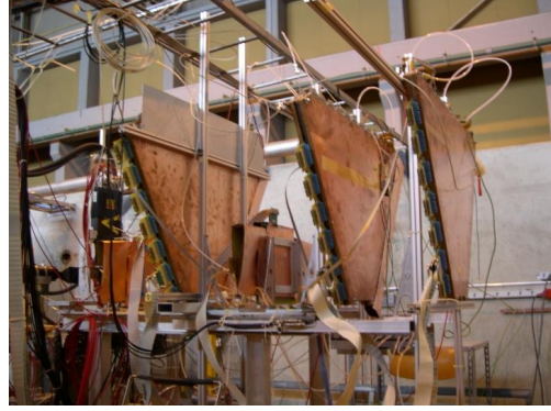
Figura 4.3: Foto dei rivelatori installati sul fascio di X5B.
