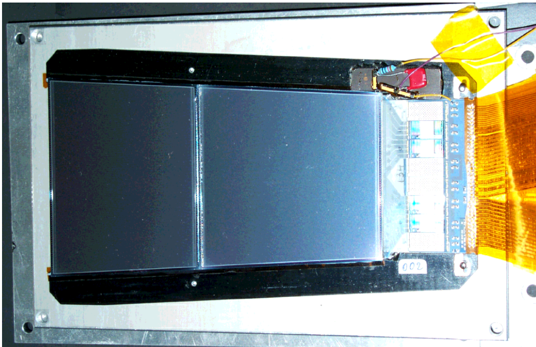
Abbildung 7.2: Trapezförmiges F1-Silicon Module Prototype nach Art eines TEC-Moduls, hergestellt aus zwei 4“-Inch Wafern, und an ein APV6-Hybrid gebondet. Konstruiert und Fertiggestellt zur Teilnahme am 25 ns Bunched-Beam-Test am CERN (Februar 2000, INFN-Florenz [BUS00]).
