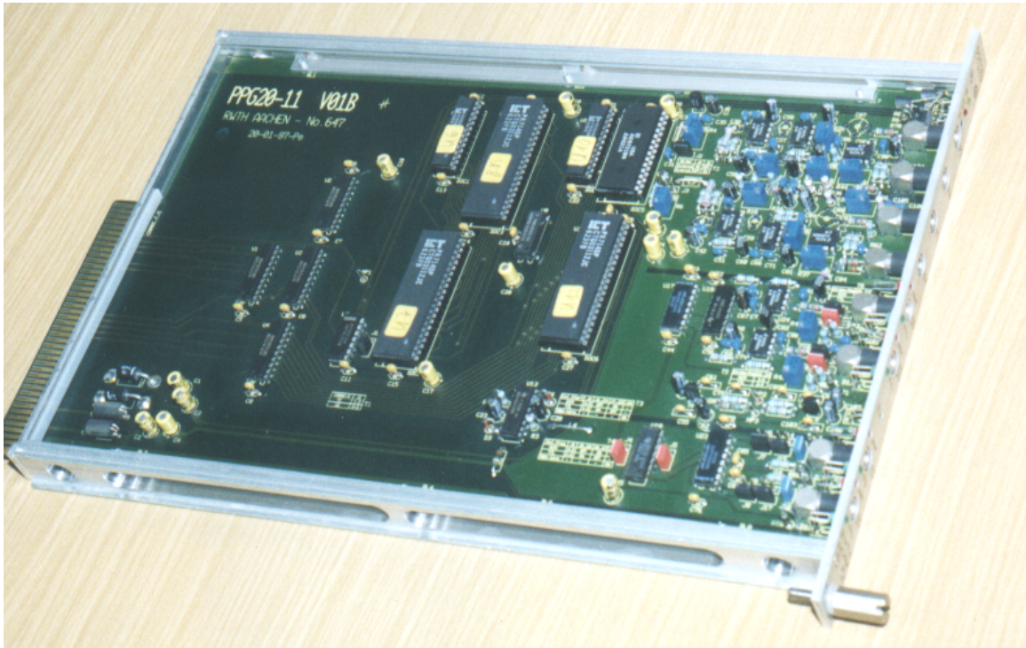
Abbildung B.6: PPG20-11, engl. Programmable Pulse Generator [PET97], einsetzbar als Testpulsgenerator für Streifendetektoren sowie als programmierbarer Veto-Signalgeber in der Triggerbox.
