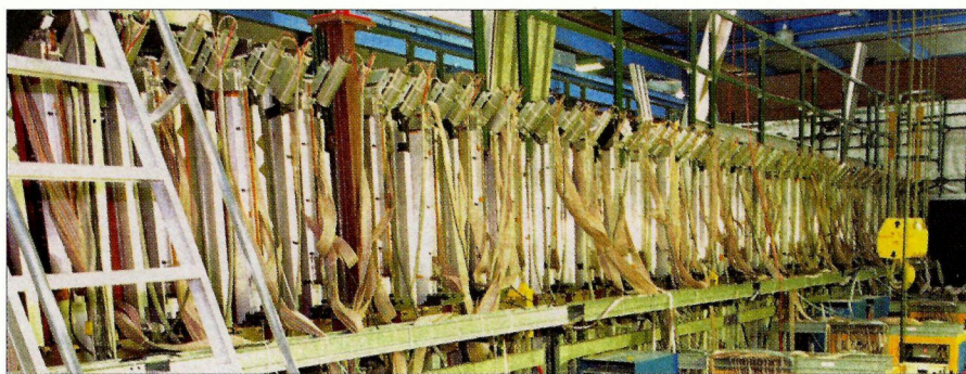
Une vue du détecteur de neutrinos NuTeV au Tévatron du laboratoire Fermi, il utilise les 700 tonnes d'une cible à plaques d'acier où l'on intercale des chambres à dérive et des scintillateurs.
