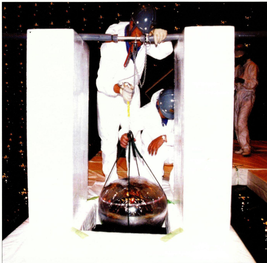
Maintenance courante sur Super-Kamiokande montrant la taille d'un photomultiplicateur.
