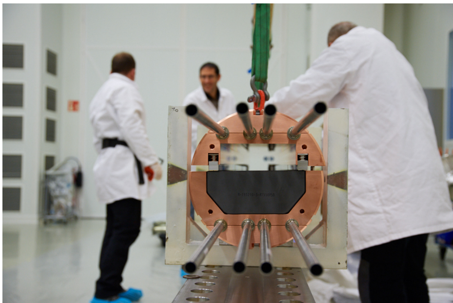
Le nouveau arrêt de faisceau interne pour le SPS, en cours d'assemblage. Le dysfonctionnement de ce dispositif limitait en 2016 le nombre de paquets qui pouvaient être injectés du SPS dans le LHC. (Image : Max Brice/CERN)
