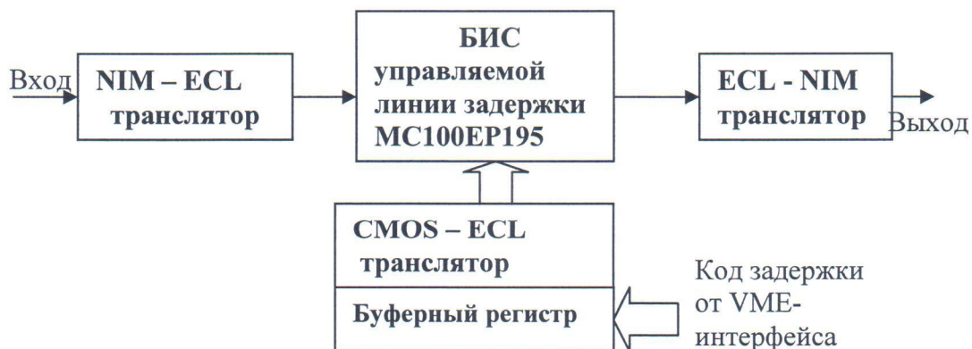
Рис. 3.42. Структурная схема модуля управляемых задержек (показан один канал модуля).
