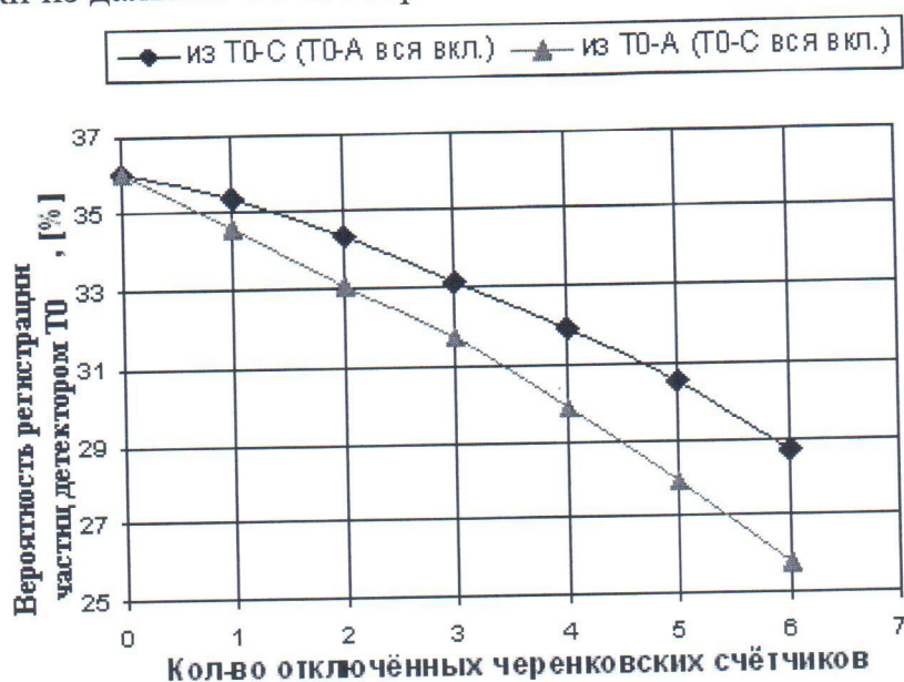
Рис. 2.34. Зависимость вероятности регистрации вторичных частиц детектором Т0 от количества отключённых черенковских счётчиков.
