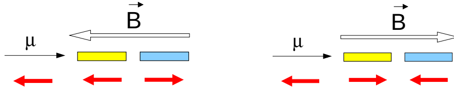
FIG. 6.8: Le réglage micro-ondes positif correspond à une polarisation positive de la cellule amont (la polarisation est mesurée par rapport à la direction du champ magnétique). L'asymétrie est calculée par l'équation (6.20).
