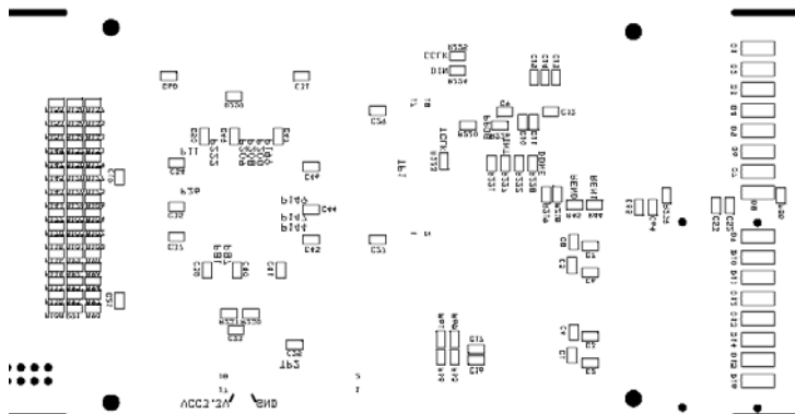
Abbildung C.8: Aufdruck der Lötseite.
