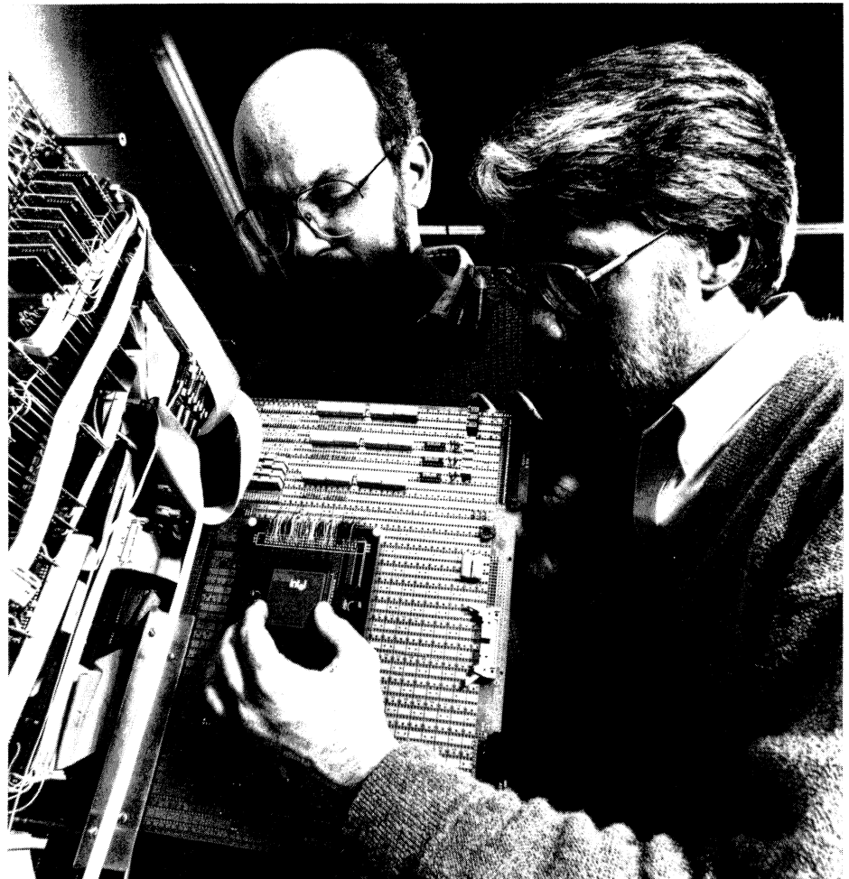
Au Laboratoire Fermi, Bruce Denby (à droite) et Clark Lindsey adaptent une puce spéciale sur la carte de réseau neuronal fixée sur la carte-mère de lecture de leur chambre à dérive. Dans cette expérience d'avant-garde d'utilisation des équipements des réseaux neuronaux, les angles et les points de rencontre des traces de muons sont calculés en ligne à partir des signaux émis par les fils sensibles analogiques de la chambre. La concordance est excellente entre les lissages des traces par le réseau neuronal et par un traitement en différé (diagrammes ci-dessous).
