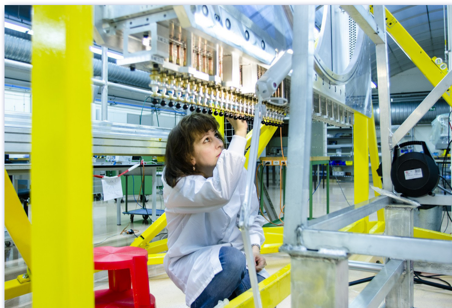
L'extrémité des pailles est collée à un cadre en aluminium, étape cruciale de l'assemblage d'un module. Les extrémités sont ensuite inspectées visuellement, avant le test d'étanchéité.
