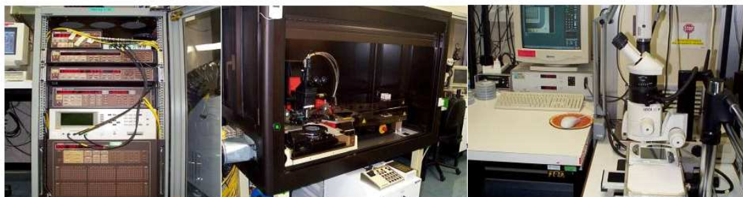
Figura 3.3: Il crate degli strumenti per la caratterizzazione elettrica, la stazione di test elettrico e il tavolo XY per l'ispezione ottica
