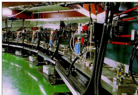
L'anneau d'amortissement de l'installation d'essai de l'accélérateur ATF au laboratoire japonais KEK a atteint des émittances de faisceau (dimension \times divergence) prometteuses pour les collisionneurs linéaires électron-positon en projet.
