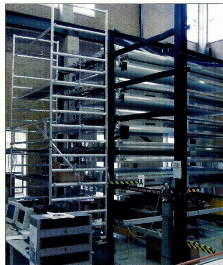
Le banc d'essai à rayons cosmiques du NIKHEF.
