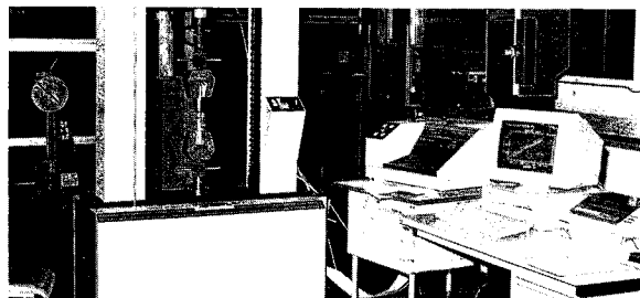
Essais de matériaux INSTRON
