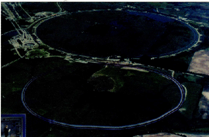
Le nouvel injecteur principal de 150 GeV et 3200 m de circonférence du Laboratoire Fermi (au premier plan) injecte des particules dans le Tévatron, de plus grande taille.
