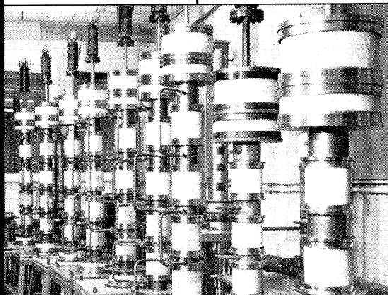
F 2009 - 30 kW moy. • 590 à 830 MHz pour émetteurs TV
