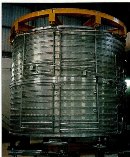
Deux modules du solénoïde de CMS chez le constructeur, Ansaldo, en Italie; le premier module est celui du bas. (Photo: INFN.)
