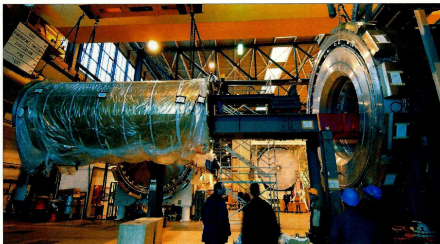
Le solénoïde supraconducteur d'ATLAS au cours de l'une des opérations de transport. Solidement attaché au pont roulant, le solénoïde est maintenant placé face à l'ouverture du calorimètre électromagnétique à argon liquide où il doit bientôt prendre place.
