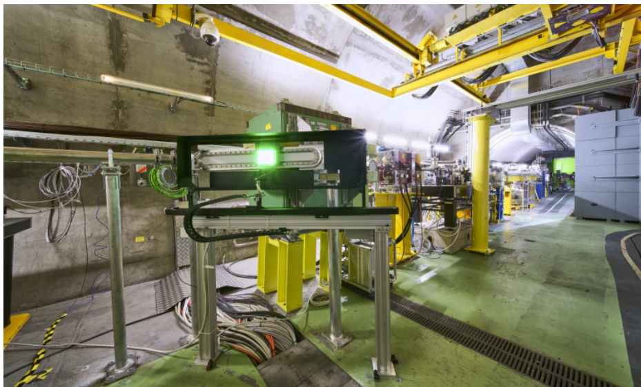
La partie finale du dispositif expérimental d'AWAKE avec la cellule accélératrice et l'écran scintillateur qui permet de détecter les électrons accélérés et de déduire leur énergie. (Image : Maximilien Brice, Julien Ordan/CERN)
