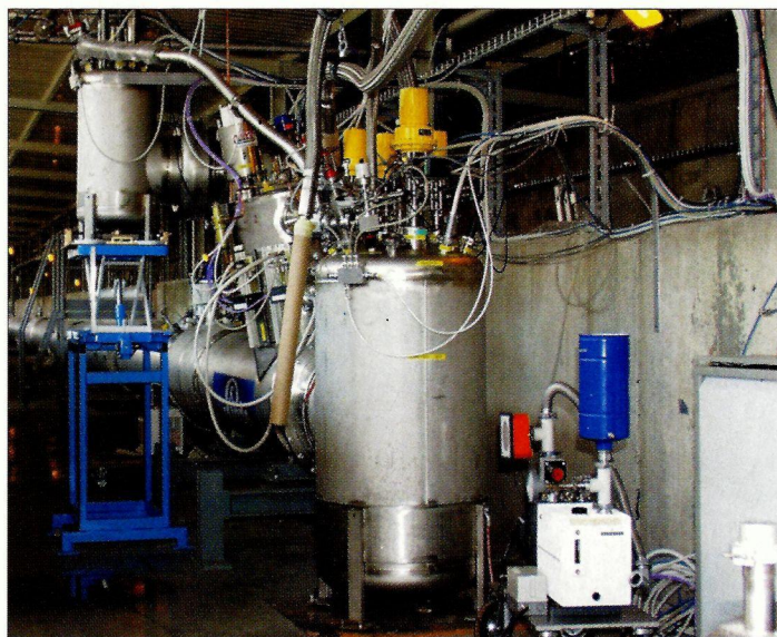
Une des trois cellules d'essai de 112 m pour la ligne de distribution cryogénique du LHC (QRL). Des caissons de terminaison ferment les interconnexions qui relieront ensuite les modules de la QRL entre eux, et les modules de service qui relieront la QRL aux cryostats des aimants du LHC. On voit ici un module de service à l'une des extrémités de la cellule d'essai.
