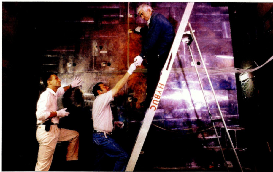
La cible en plomb de l'expérience TARC au CERN reprend du service pour la future installation de neutronique par temps de vol.
