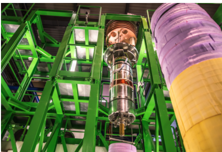
Le tiers d'une série de modèles courts ont été soumis à des essais, qui ont été concluants. Les essais ont été effectués dans la station de test en vertical récemment mise en service dans le hall SM18. (Image : Noemi Caraban Gonzalez/CERN)
