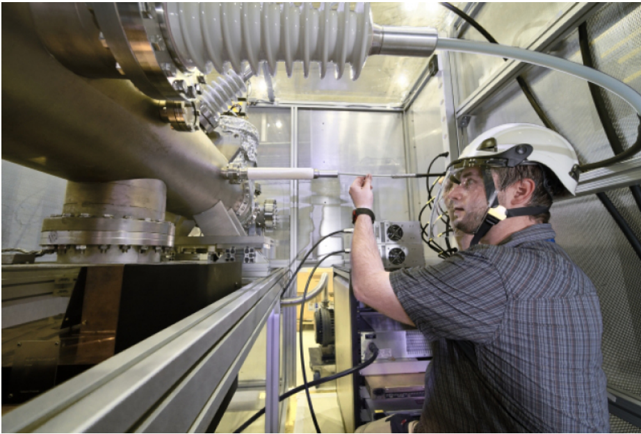
Audric Husson en train de travailler sur le tout nouveau Décélérateur d'antiprotons de GBAR, que son équipe a conçu et installé, et qu'elle met actuellement en service. (Image : Maximilien Brice/CERN)
