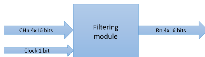
FIGURE 4 – Schéma global d'un module de filtrage
