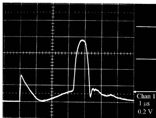
FIG. 7.3 – Puissance incidente alimentant la structure NAS.
