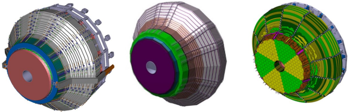
Figure 2.9: Vue 3D de HGCal avec sa structure mécanique à gauche, son système de refroidissement au milieu, et l'assemblage des couches hexagonales à droite.
