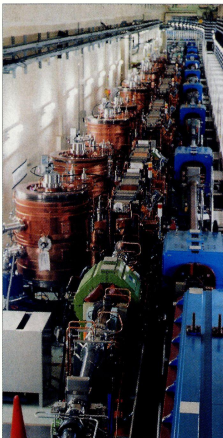
Les anneaux parallèles d'électrons et de positons du collisionneur KEKB. (Avec la permission du KEK.)
