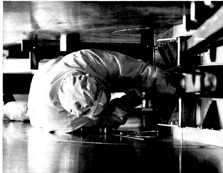
2. Vu la radio-activité à l'intérieur du tank à vide du cyclotron, les travaux ont dû, ici, être exécutés rapidement et avec précision. Cette tâche n'est guère facilitée par l'é étroitesse de l'entrefer séparant les deux pôles de l'aimant.
