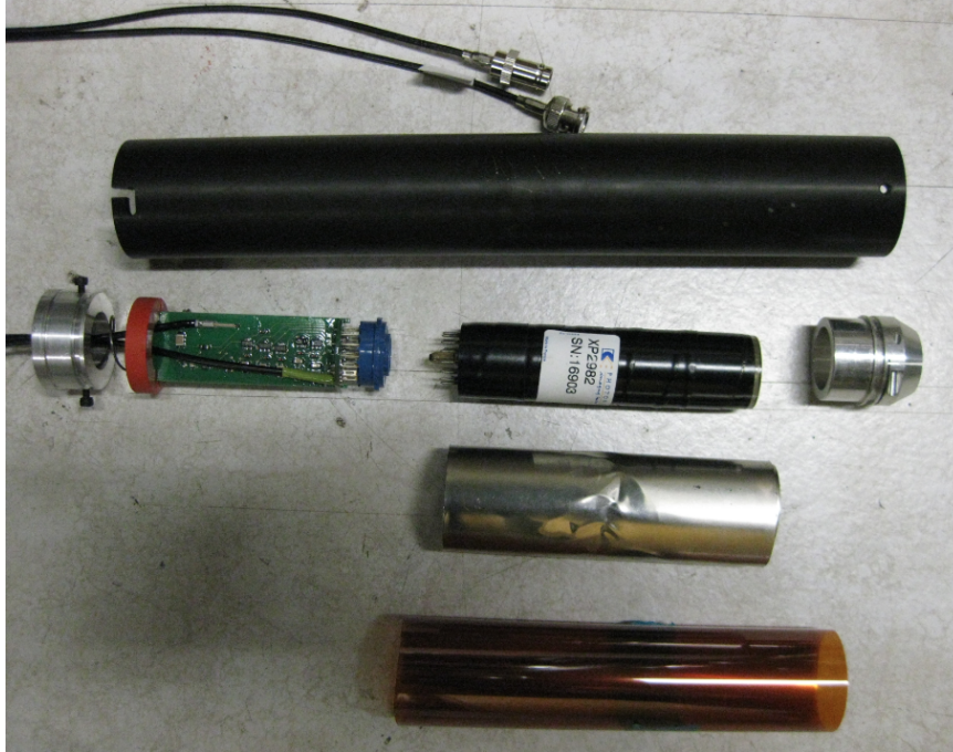
Abb. 1.6.: Die Weicheisenabschirmung mit den in ihr verbauten Komponenten. Von oben nach unten: Photomultiplierbasis mit Photomultiplier und Aluminiumanschluss an den Lichtleiter, die \mu -Metallabschirmung und die Kaptonfolie zur Isolierung [7]
