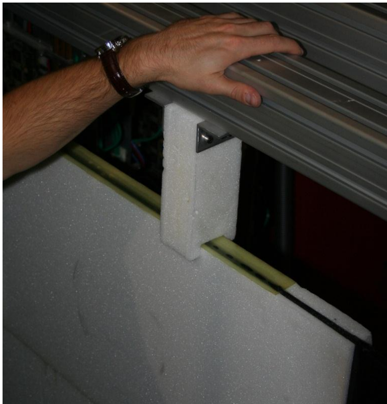
Abb. A.8.: Eingebaute Distanzstücke aus Rohacell zur Stabilisierung am oberen Rand
