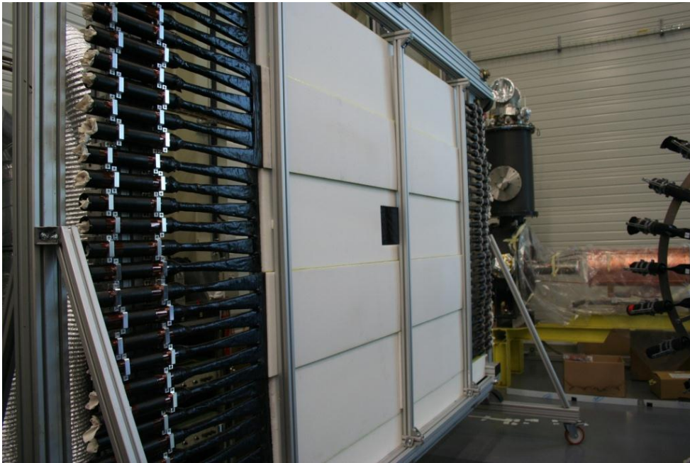
Abb. 1.4.: Aufnahme von H1. Die versetzte Stapelfolge der einzelnen Gruppen ist deutlich zu erkennen.
