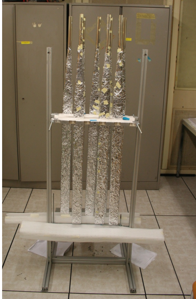
Abb. A.1.: Foto des Haltegestells mit eingespannten Szintillatoren. Zum Schutz der Szintillatoren wurde auf die Platte noch polsternde Folie gelegt.
