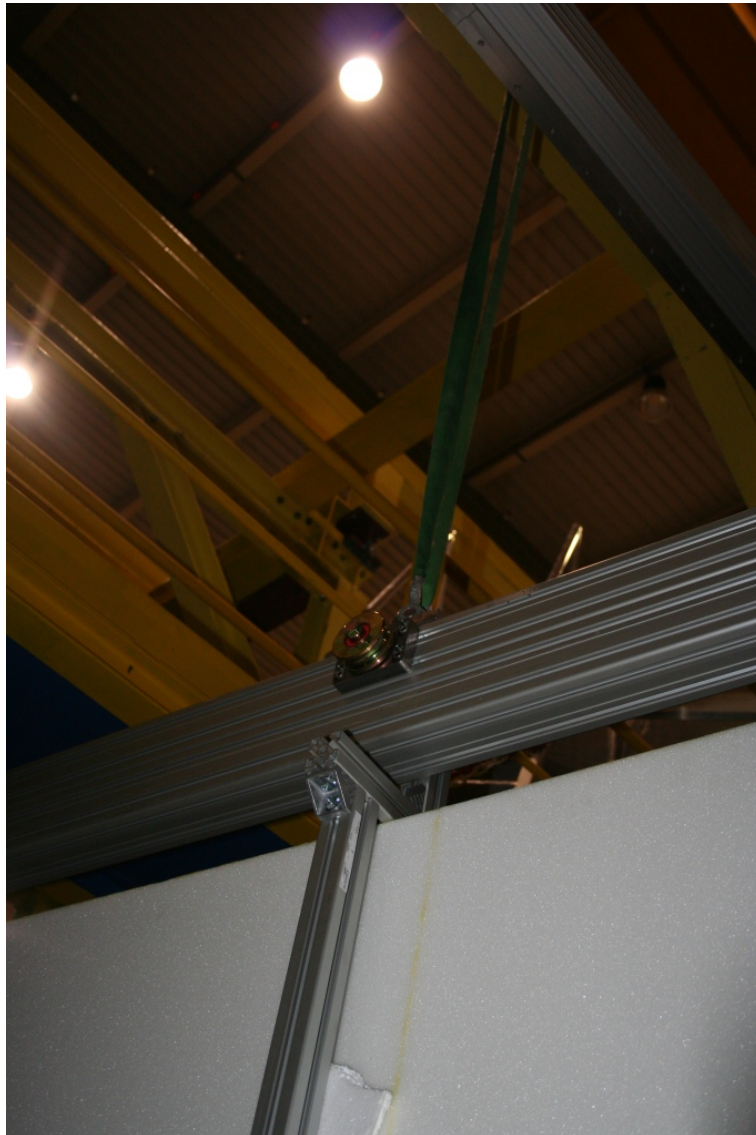
Abb. A.4.: Befestigung des Gurtes zum Drehen von H1. Das Foto wurde von der Juraseite strahlabwärts blickend aus gemacht. In der oberen rechten Ecke ist die Trageschiene zu erkennen.
