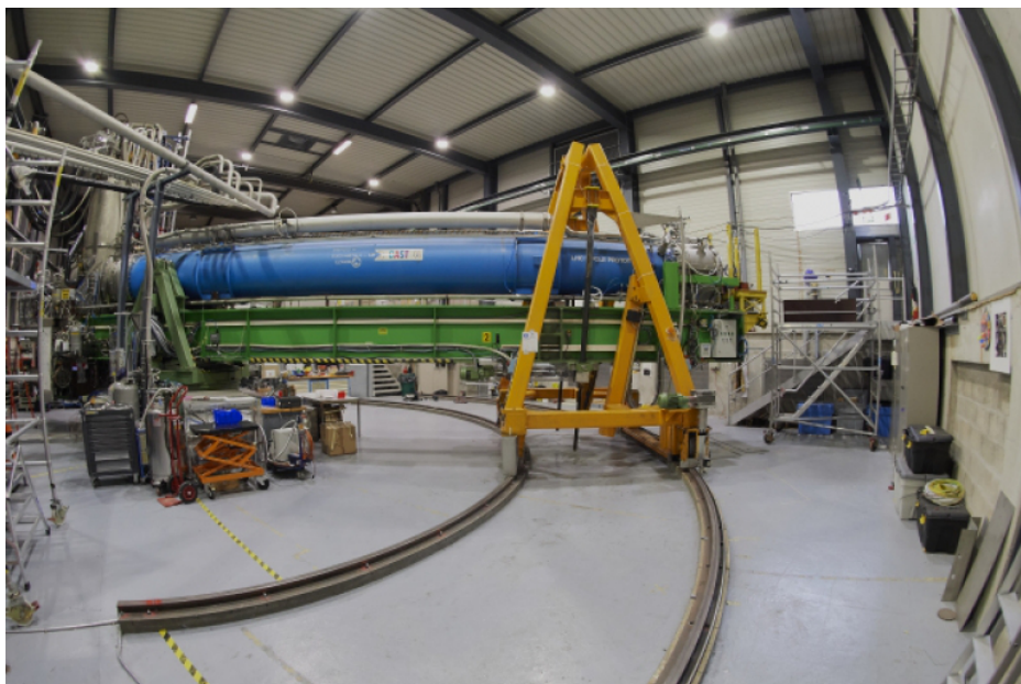
En se déplaçant sur ses rails, CAST, le télescope à axions solaires du CERN, suit le mouvement du Soleil une heure et demie à l'aube et une heure et demie au crépuscule. (Image : Max Brice/CERN)
