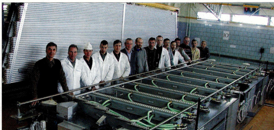
Le groupe de Protvino pose auprès du gabarit d'assemblage des grandes chambres à dérive à contrôle continu. Derrière eux se trouve l'une des plus grandes chambres, de 6,3 m de longueur, destinée au bouchon d'ATLAS pour muons.
