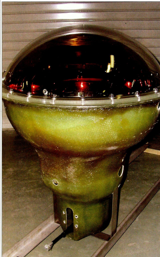
Les tubes photomultiplicateurs reconstruits du détecteur Superkamiokande seront enfermés dans des globes d'acrylique et de plastique renforcé de fibres qui préviendront la propagation des ondes de choc en cas d'implosion d'un tube.
