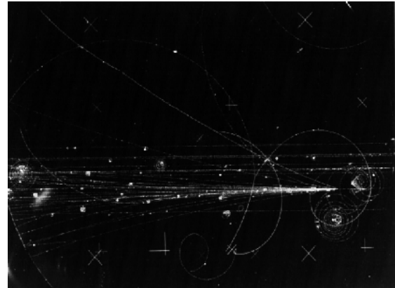
Figuras A6 y A7. A la izquierda detalle de cascada electromagnética en la cámara de burbujas de 15 pies (457.2 cm) en Fermilab. A la derecha detalle de cascada hadrónica con cámara de burbujas de 30 pulgadas (76.2 cm) de Fermilab.
