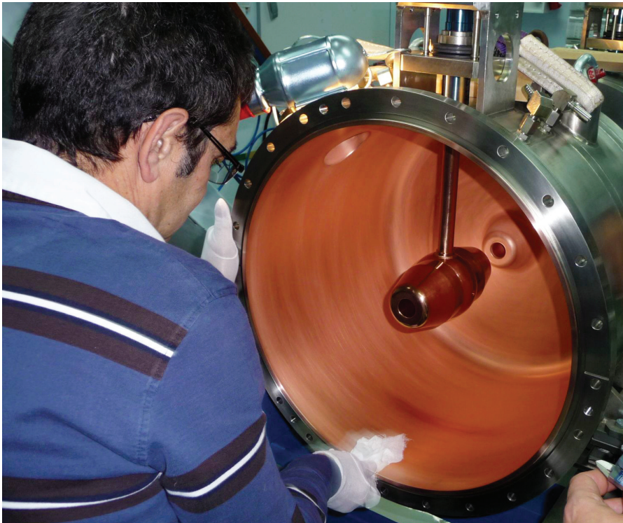
Préparation de la portée du joint qui sert à obtenir l'étanchéité au vide entre les demi-cellules composant les pièces du module.
