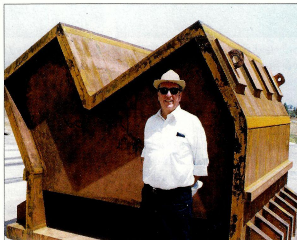
Sur un bon pied. Le directeur-général du CERN Luciano Maiani à Taxila, au Pakistan, devant l'un des pieds de 25 tonnes qui supporteront l'aimant de l'expérience CMS auprès du collisionneur LHC du CERN. Ces éléments sont fournis par l'entreprise Scientific Engineering Systems de Taxila, au titre de la contribution du Pakistan à la collaboration CMS.
