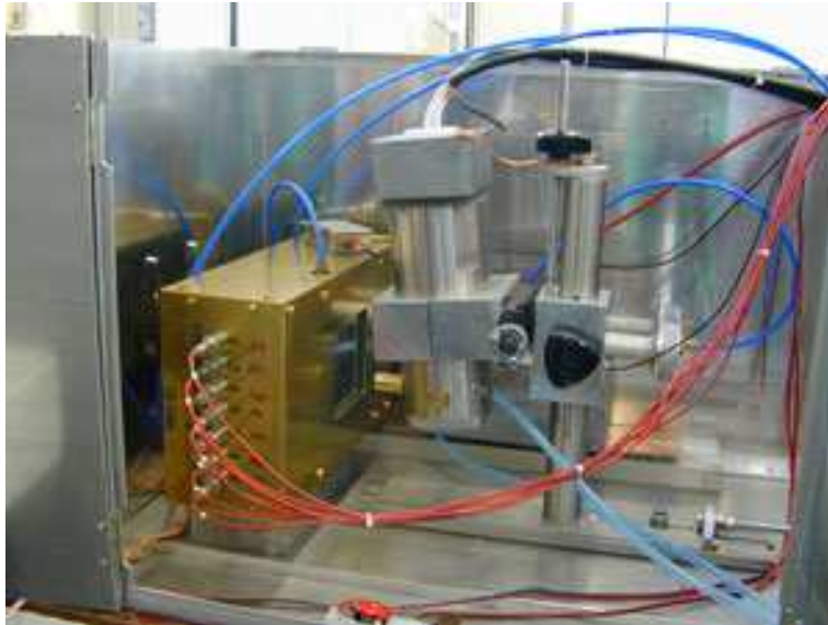
Figura 4.1: Stazione di raggi X utilizzata per le misure con i prototipi di test.
