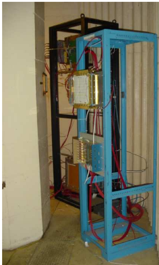
Figura 4.28: Posizione delle camere nel test. Sul rack blu si trovano, dall'alto verso il basso, la coppia di camere finali A e B e il prototipo di test D. Sulla faccia laterale del rack nero, dove la radiazione è meno intensa, è invece posizionata la camera C
