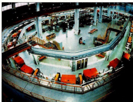
Fig. 1. L'anneau de stockage de 3,5 GeV/c de COSY (Cooler Synchrotron, synchrotron refroidisseur) sans son blindage.
