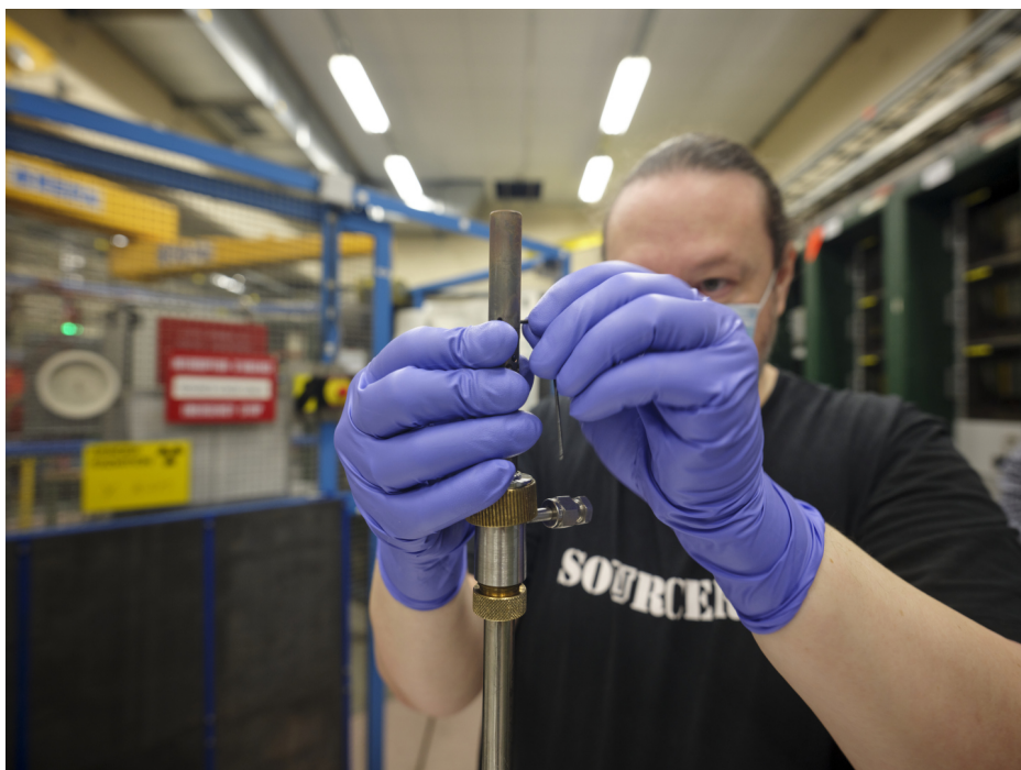
Detlef Küchler referme le micro-four après l'avoir rechargé en plomb. (Image : CERN)
