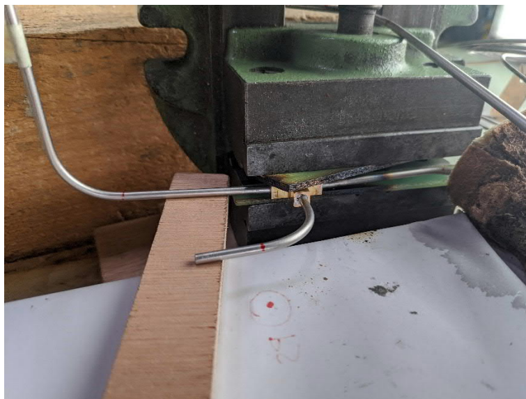
Figura 68. Instalación de los conectores en T.
