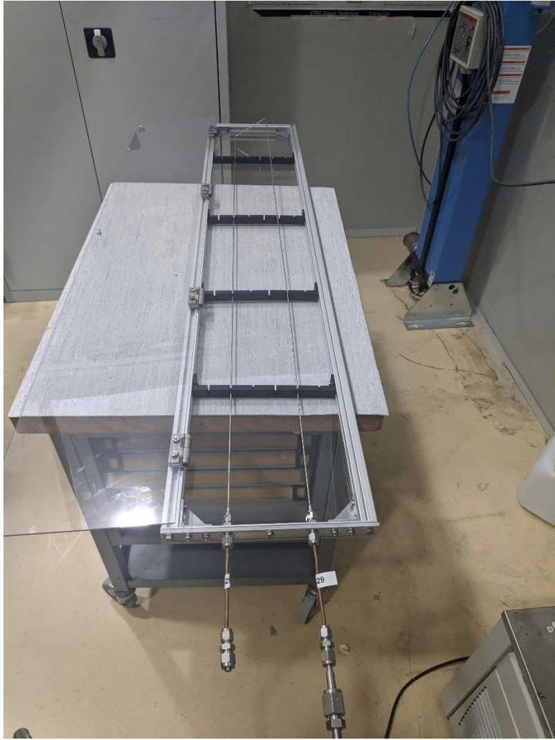
Figura 48. Detalle del montaje para la prueba de fuga de helio de los evaporadores.
