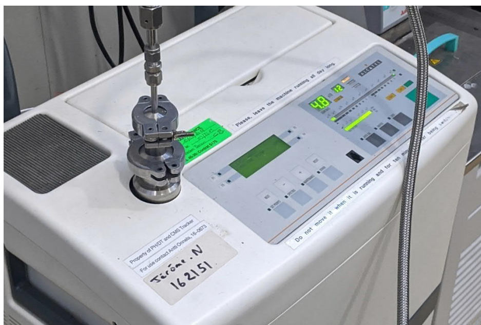
Figura 80. Resultado de la prueba de fugas de helio del colector de entrada.
