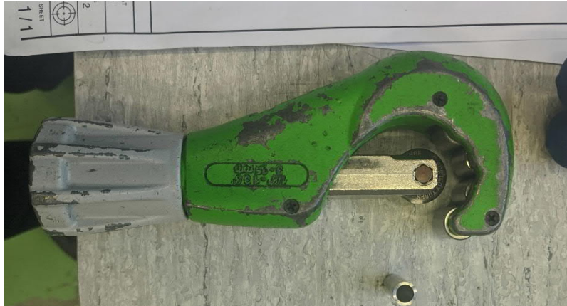
Figura 17. Herramienta para cortar los tubos.
