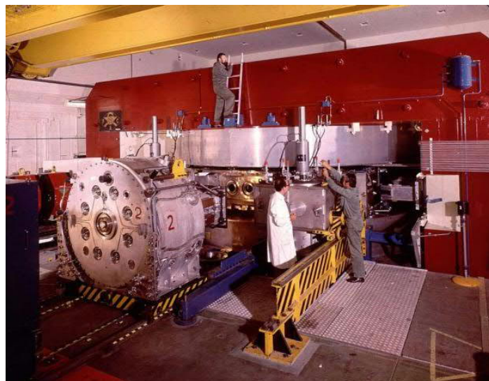
Figura 1. Montaje del Sincrociclotrón (SC). [1]
