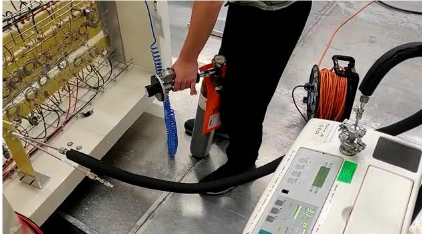
Figura 73. Prueba de fuga con helio del conjunto experimental.
