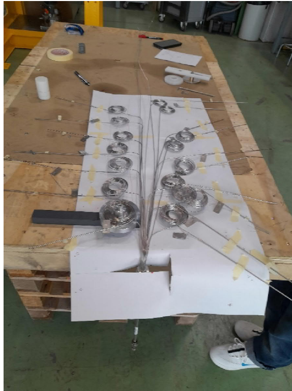
Figura 65. Enrollado de los 19 capilares.
