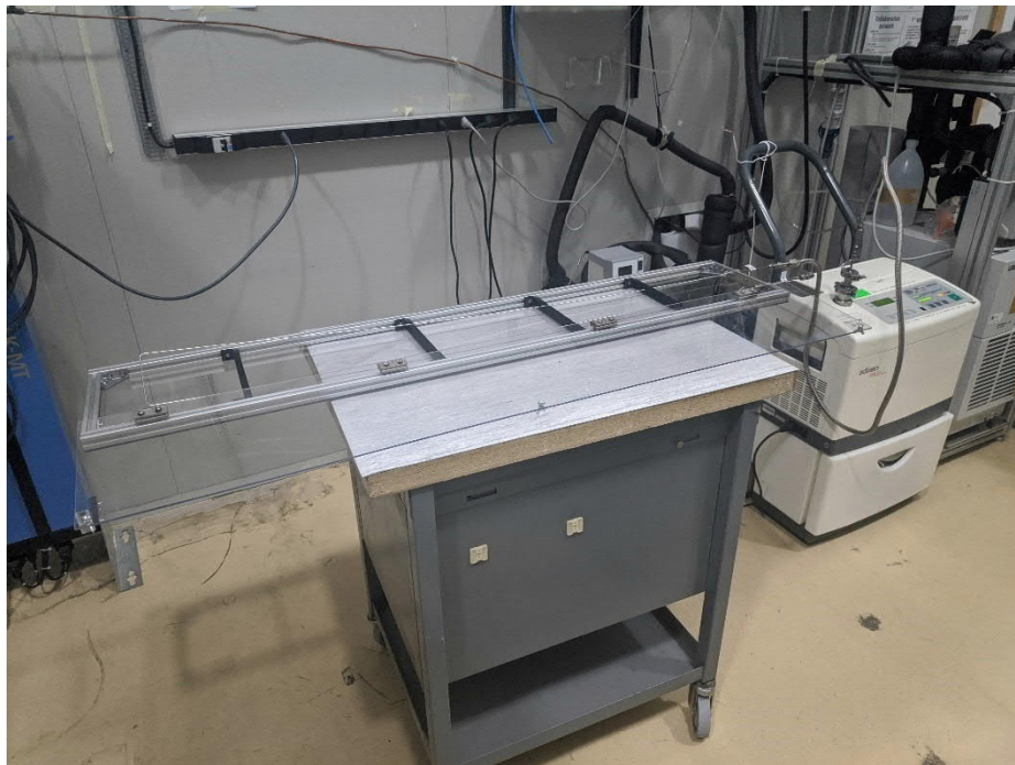
Figura 47. Prueba de fuga de helio de los evaporadores.
