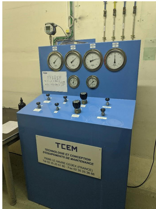
Figura 52. Sistema de control para la prueba de resistencia a alta presión.
