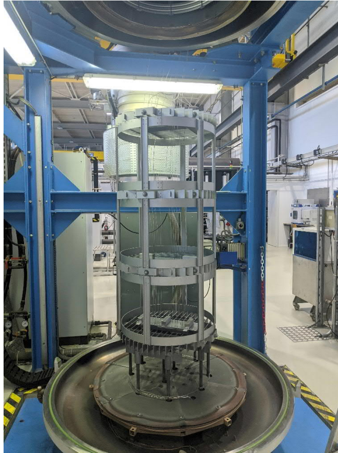
Figura 34. Colocación de capilares en el horno de soldadura al vacío.
