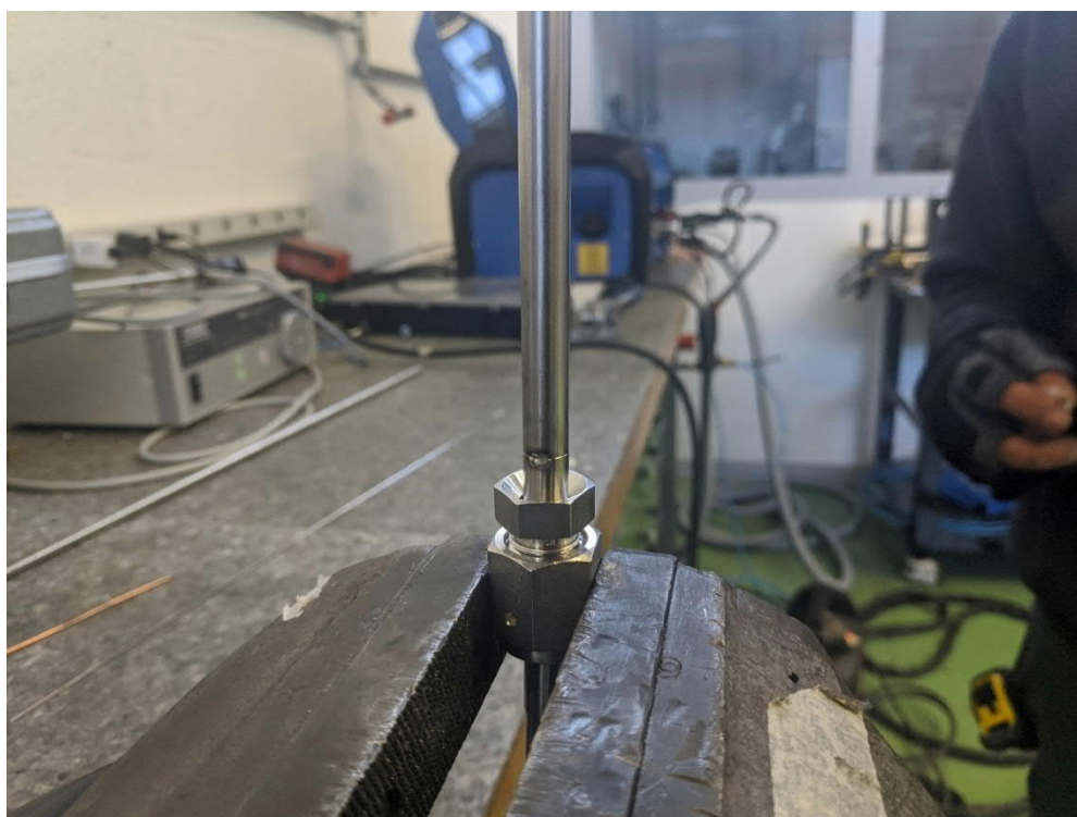
Figura 19. Alineación de la soldadura orbital.
