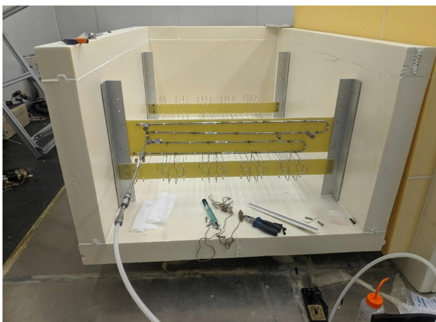
Figura 59. Verificación de la soldadura blanda de los tubos de conexión.
