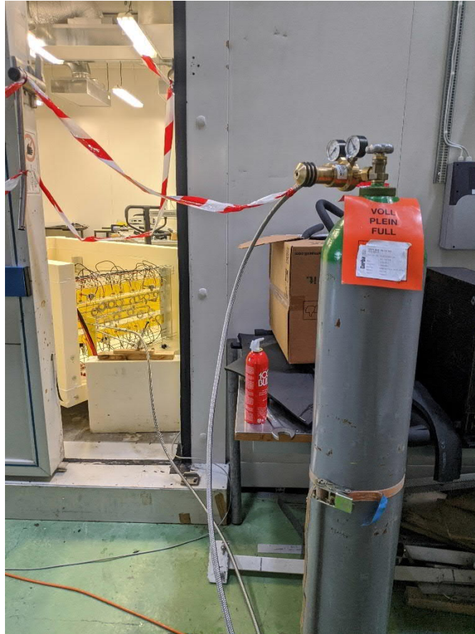
Figura 74. Prueba de fugas a alta presión del conjunto experimental.
