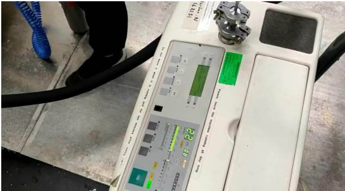
Figura 84. Resultado de la prueba de fugas de helio del conjunto experimental.
