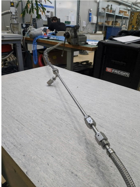
Figura 49. Montaje para la prueba de fuga de helio del colector de entrada.
