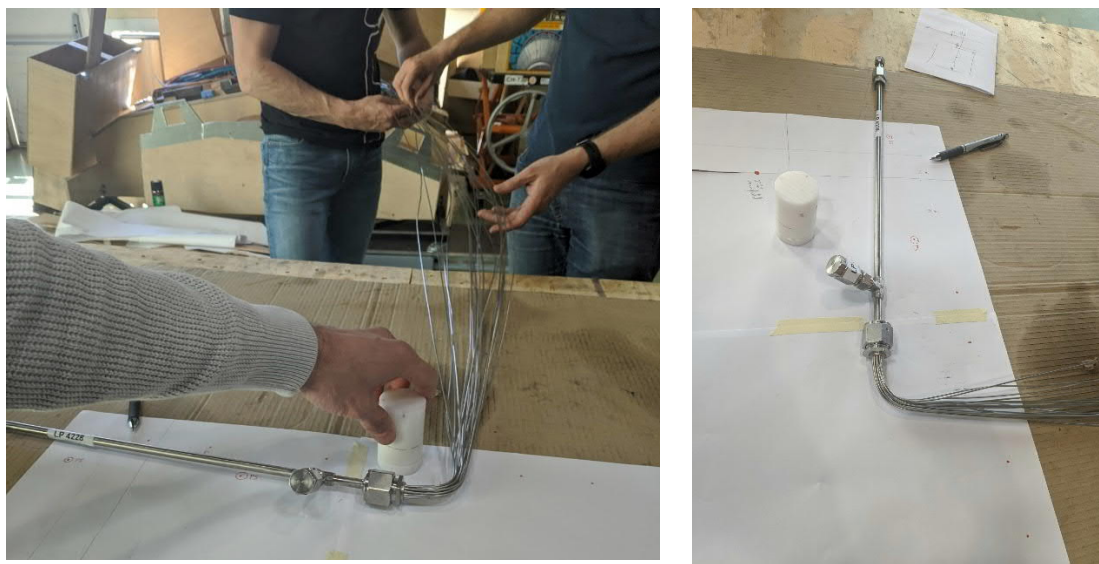
Figura 62. Primer doblado de los capilares.
