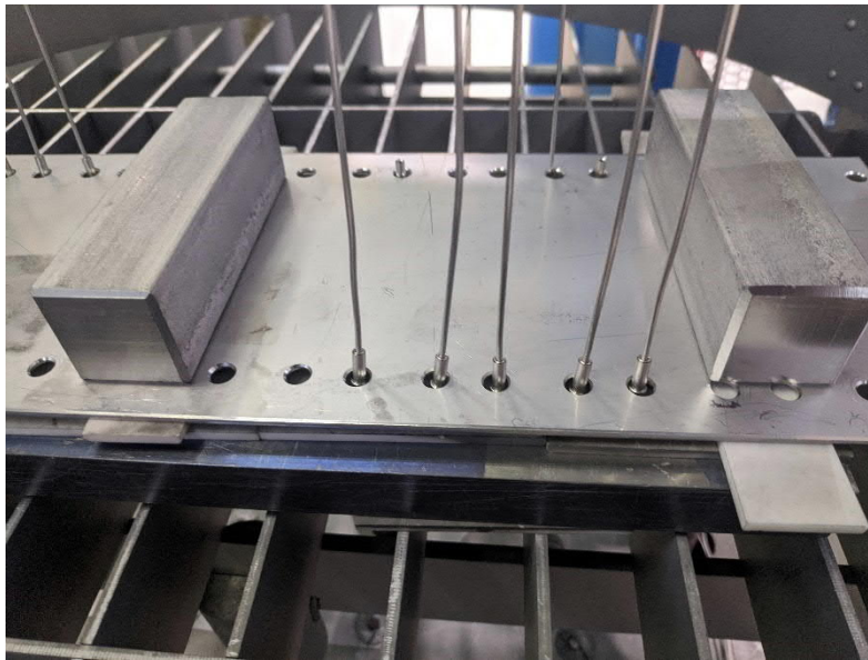
Figura 33. Colocación de capilares para soldadura al vacío.
