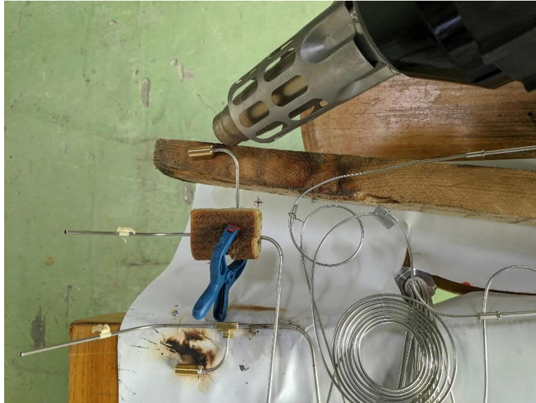
Figura 69. Instalación del adaptador para el sensor de presión.
