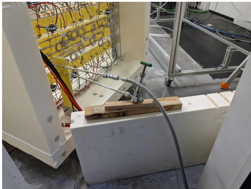
Figura 75. Detalle de la conexión entre la botella de Argón y el conjunto experimental.
