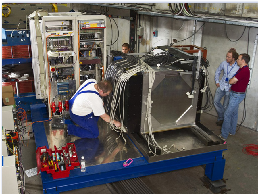
Prototype de calorimètre hadronique constitué de tungstène, pour le détecteur du collisionneur linéaire au moment de l'installation des scintillateurs CALICE. (Image : CERN/M. Brice)
